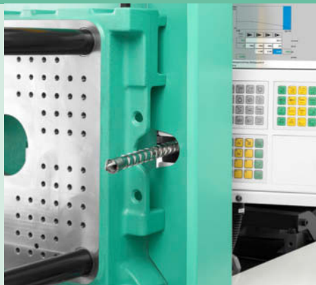
易於維護：通過可擺動的注塑單元更換螺桿。
