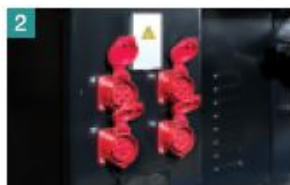
2 外置电源插座 16A X 4 (80-220t), 16A X 2, 32A X 2 (260-560t), 方便接驳辅机
