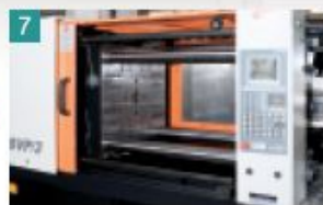
7 头板, 二板采用特厚铸件, 改善模具受力, 减少披风产生
